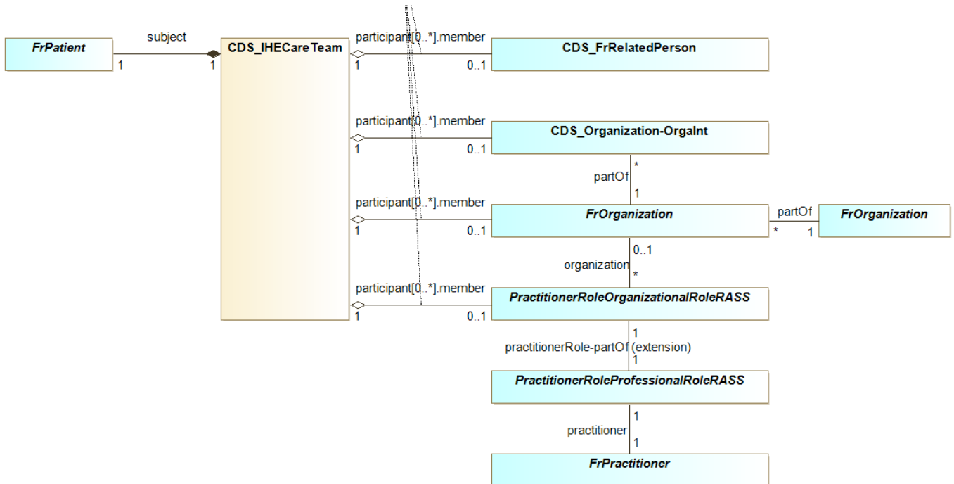
Figure 1 Représentation des ressources FHIR liées entre elles par des éléments de type « Reference »
